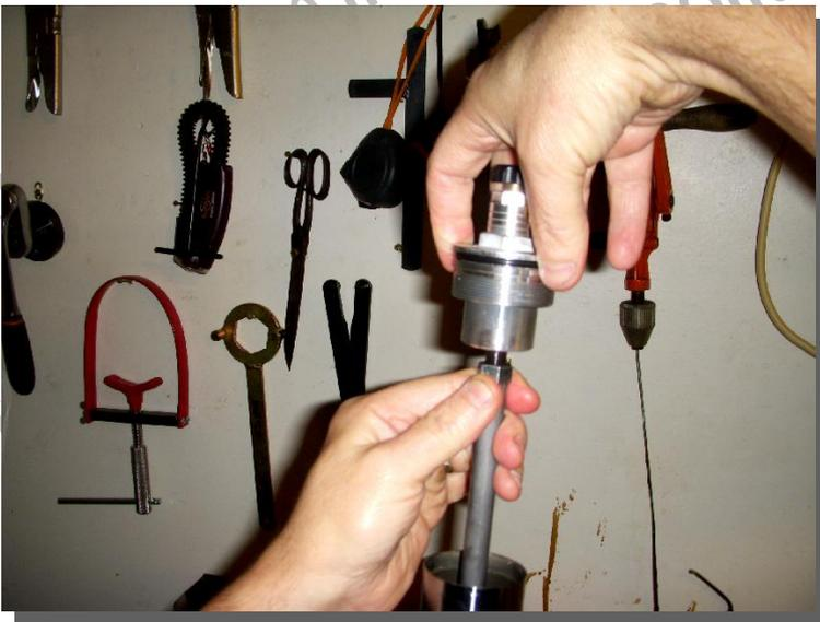
Immobilise le bouchon de fourche et serre l'écrou (1) au couple 25Nm
